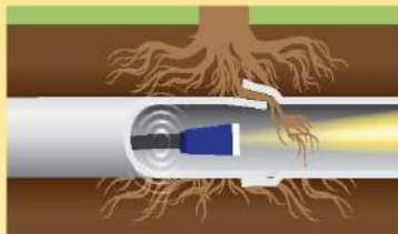
Tubería con INTRUSIÓN DE RAÍCES con una cámara que muestra su ubicación.
