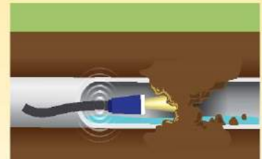
TUBERÍA APLASTADA con una cámara que muestra su ubicación.
