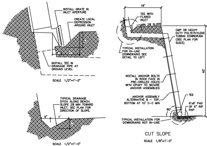
TYPICAL DOWNSLOPE DRAIN DETAIL
